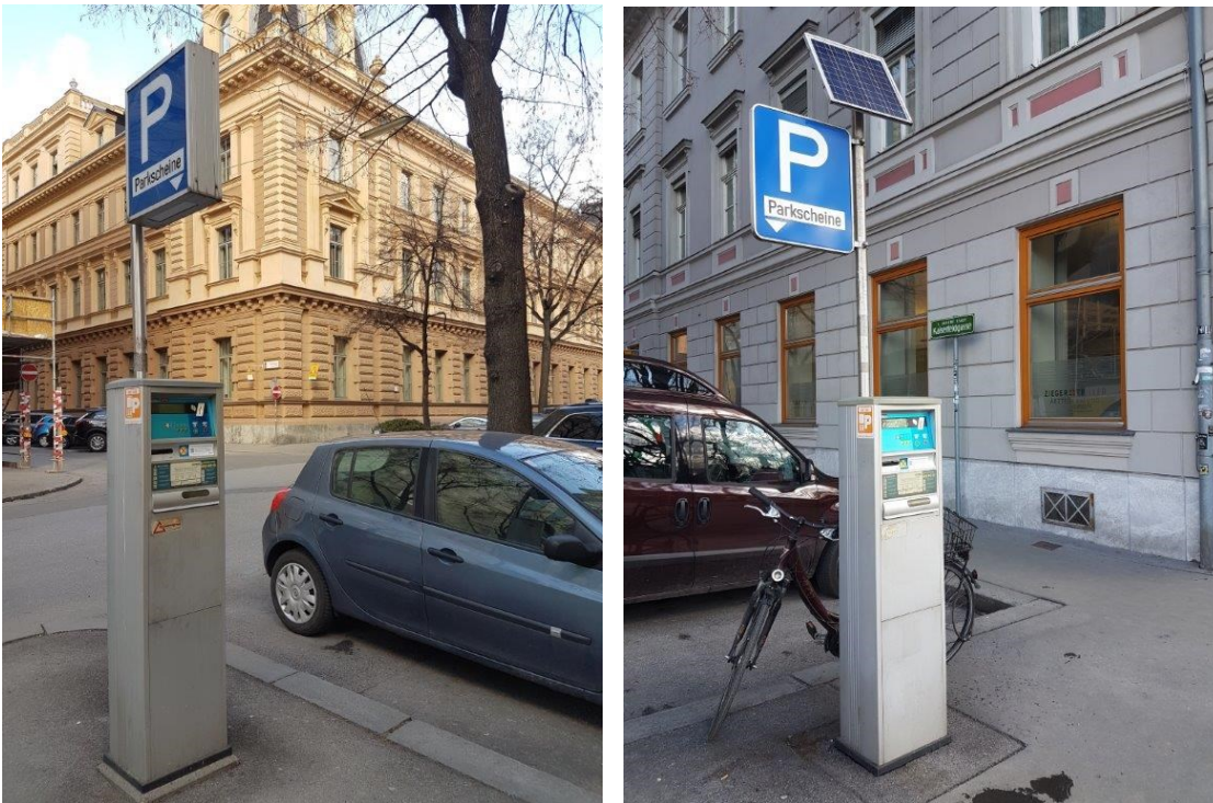
Abbildung 1: Parkscheinautomaten Bestand mit Stromanschluss bzw. mit Solarpanel Quelle: Foto StRH
