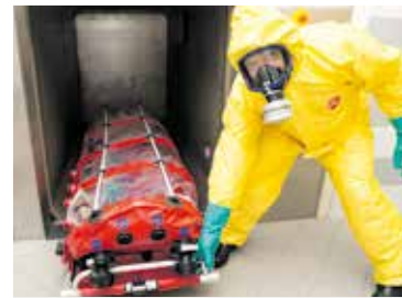
Heiß. Die vorher desinfizierte Transportrolle des Inkubators kommt in den Dampfkessel.
