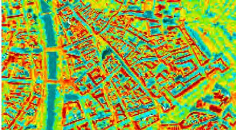
**Industrie- und Gewerbeflächen:** Dieser Typ weist die höchsten Versiegelungsraten auf, was sich auch sehr deutlich in den erzielten Mitteltemperaturen niederschlägt. 2004 errechnet sich hier eine Mitteltemperatur von  $\sim 30^\circ\text{C}$  gegenüber  $\sim 32^\circ\text{C}$  im Jahre 1986. In der folgenden Abbildung 27 sind die Hallendächer der Magna Steyr Fahrzeugtechnik im Süden der Stadt abgebildet. Die rote Farbgebung zeigt die extreme Erwärmung gegenüber dem Umland.
