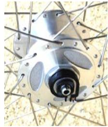
**Nabendynamo:** der Rolls Royce unter den Dynamos. Nachrüstung aufwändig; sehr betriebssicher (auch bei Nässe, Verschmutzung und Schnee; verschleißarm) getriebelose Nabendynamos können nicht abgeschaltet werden (Lichtschalter notwendig, geringer Kraftaufwand auch ohne Licht) Wirkungsgrad bis zu 70% (getriebelose) bzw. 35-40% (Getriebedynamo) Preis: ca. € 60,- bis € 150,-
